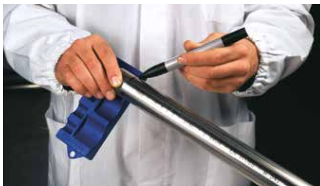
Fig. 28 - Markering af indstiksdybde
