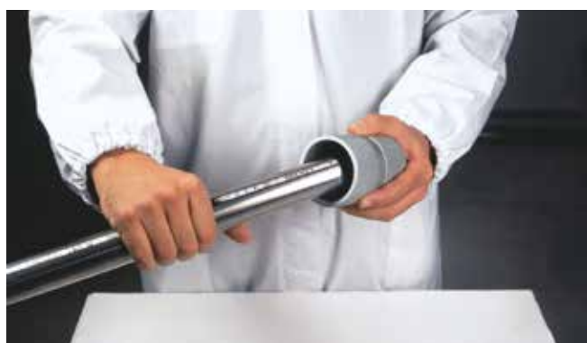
Fig. 26 - Afgratning af rør
