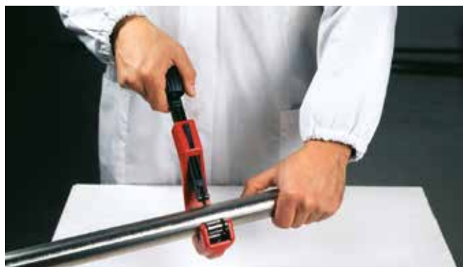
Fig. 25 - Tilskæring af rør
